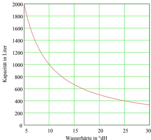
Abbildung 1; Kapazität des Einbauwasserenthärter
