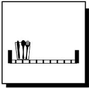
Bei Benutzung von Besteckkörben und -köchern sind die Besteckteile immer mit den Handgriffen nach unten einzuordnen. Es ist ferner darauf zu achten, daß in einem Köcher Löffel, Messer und Gabeln möglichst gemischt eingestellt werden, da sich gleichartige Besteckteile eng aneinander legen könnten. Natürlich darf auch die Anzahl der Besteckteile pro Köcher nicht zu hoch sein.
