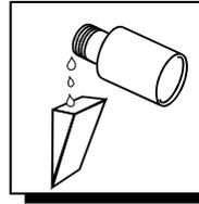
Der Klarspüler hat in erster Linie die Aufgabe, die Oberflächenspannung des Nachspülwassers zu verringern. Dadurch wird die einwandfreie Glanztrocknung erreicht
