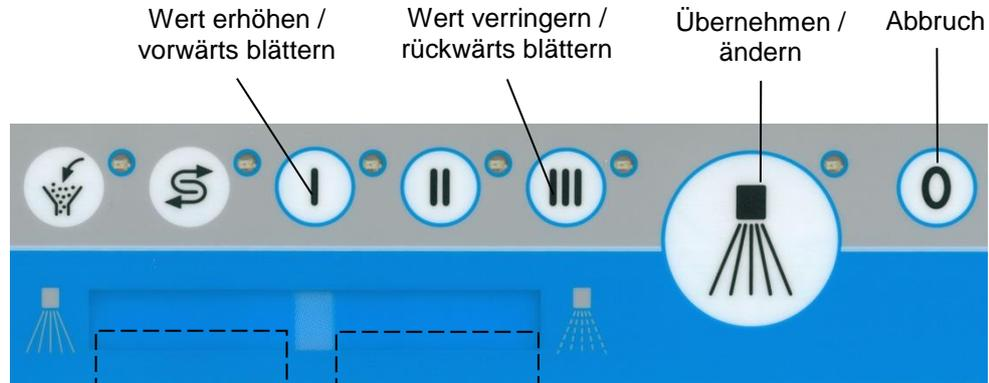
Es wurden verschiedene Zugangscodes für die verschiedenen Benutzerebenen definiert. Nach vollständiger Eingabe wird der eingegebene Code mit einer internen Code-Tabelle verglichen. Abhängig vom eingegebenen Code wird in die entsprechende Benutzerebene verzweigt.
