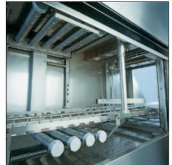
**MEIKO-Blockwaschsystem oben und unten** mit zusätzlich seitlichen Wascharmen. Ein einfacher Schnellverschluss garantiert das **äußerst leichte Handling** beim Entnehmen und Einsetzen. Die großen Düsenöffnungen sorgen nicht nur für **perfekte Reinigungsdynamik**, sondern auch für hohe Verstopfungs-Unempfindlichkeit.
