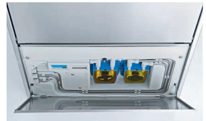
Um die Betriebssicherheit zu erhöhen, setzt die *M-iClean* konsequent auf mehr Edelstahl – wie hier bei den Dosierleitungen.
