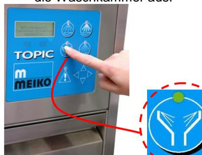
5. Wählen Sie das Reinigungsprogramm „Waschkammerspülung“ und starten Sie das Programm durch leichten Druck auf diese Programmtaste.
