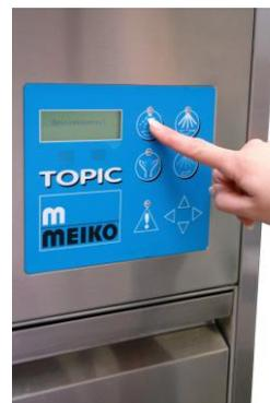
Wählen Sie nun das richtige Reinigungsprogramm entsprechend der Verschmutzung aus, und starten Sie das Programm durch leichten Druck auf die entsprechende Programmtaste.
