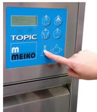
Um das Programm abubrechen, drücken Sie die Fehlerquittiertaste
