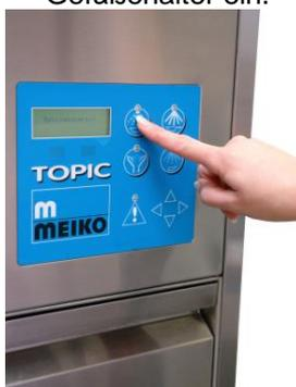
5. Wählen Sie das Reinigungsprogramm entsprechend der Verschmutzung aus, und starten Sie das Programm durch leichten Druck auf die entsprechende Programmtaste.
