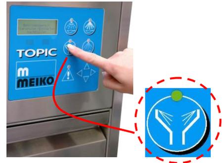
3. Starten Sie die Randspülung für den separaten Ausguss durch leichten Druck auf die Taste „Randspülung“.
